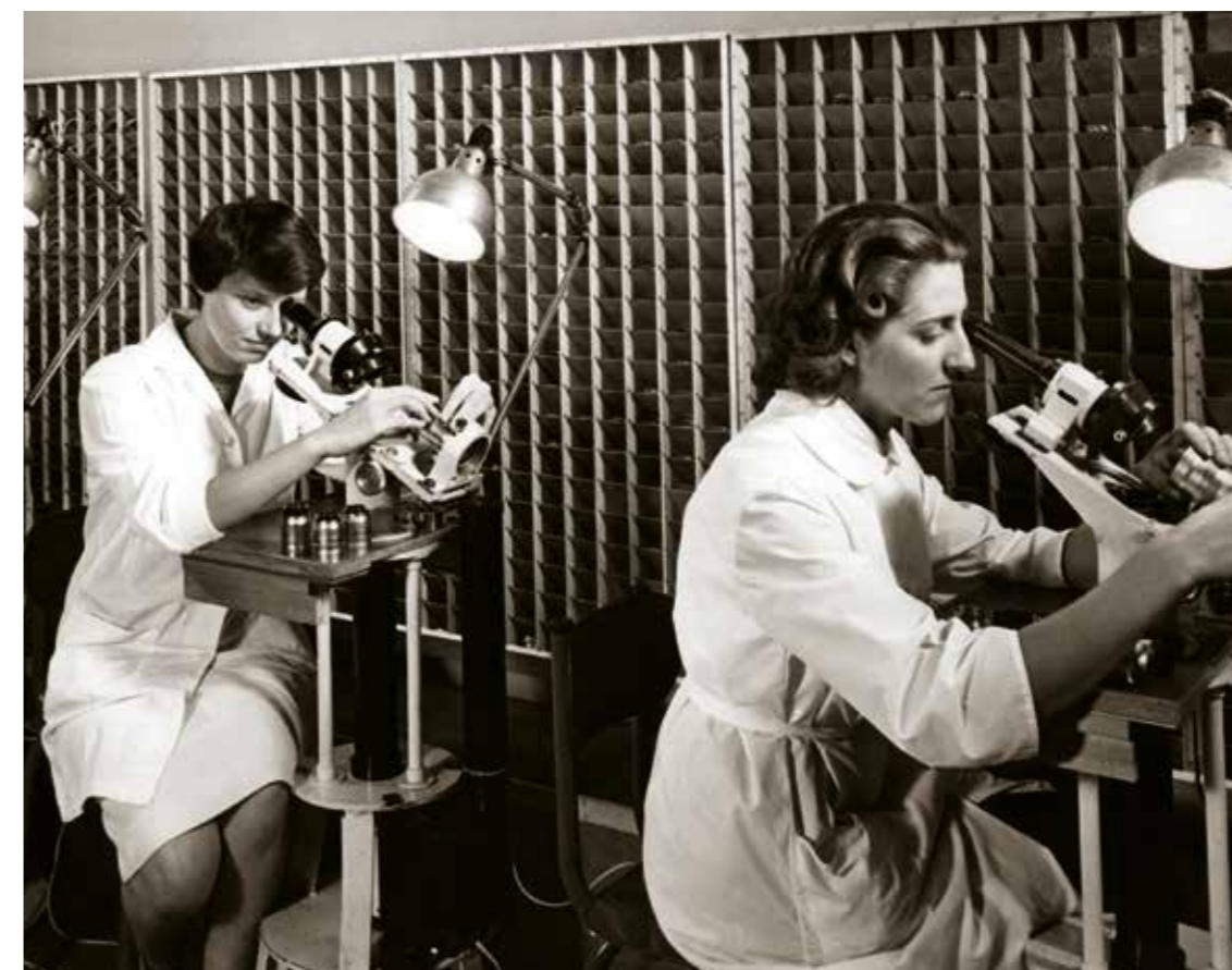
Postes de centrage des objectifs sur collimateurs avant réglage, Angénieux années 1960 (Photographie Ito Josué, archives Thales Angénieux)
