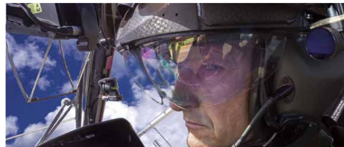
Casque TopDwl équipé d'un système de vision augmentée Thales Angénieux, dans le cockpit d'un hélicoptère Tigre (Photographie E. Raz, Archives Thales Angénieux)
