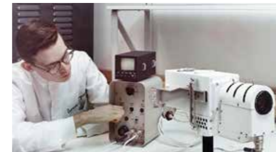
Test du zoom Angénieux pour la mission Skylab, première station spatiale, lancée par la NASA en 1973 (Archives Thales Angénieux)
